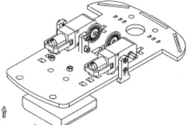
Pomocí přiložených šroubů M3\*6mm připevněte držák baterií z druhé strany podvozku.
