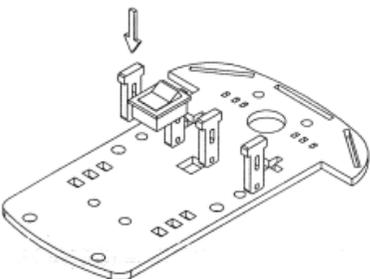
Odstraňte žlutý ochranný obal z podvozku. Vezměte 4ks držáky motorů a zasuňte je do podvozku. Do otvoru uprostřed zasaďte zapínací tlačítko.
