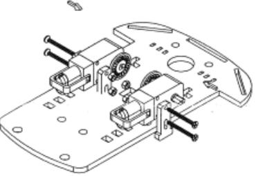
Upevněte motory pomocí přiložených šroubů M3\*30 mm a matic a utáhněte.
