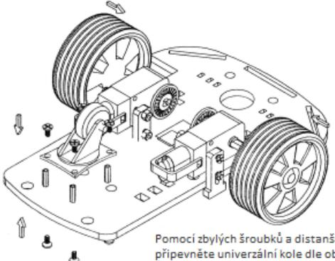
Pomocí zbylých šroubků a distančních sloupků připevněte univerzální kole dle obrázku. Na motory nasaďte kola.
